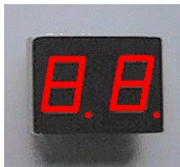
Bild 3. LED display med två siffror
