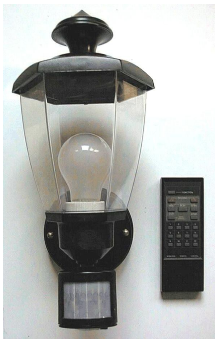
Bild 1. Användningsområden, yttre belysning med passiv IR övervakning, fjärrkontroll med aktiv IR överföring.
